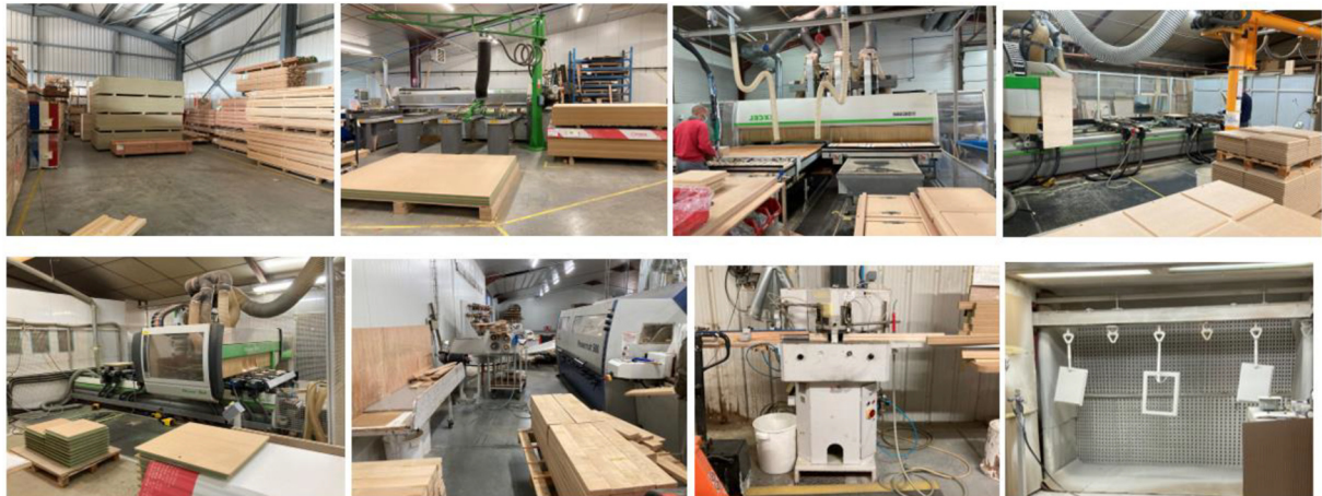
Figure 3 : Ligne de production actuelle, flux trappes. De gauche à droite : Absence de moyen de stockage optimal ; scie à panneaux ; usinage Excel ; Rover ; Moulurière ; îlot contre-cadre ; tunnel de laquage
